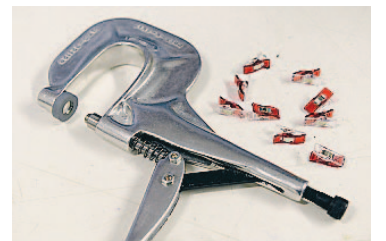
Här är några av de verktyg som behövs när det gamla bohaget ska kläs om. Multipressen används till att trycka fast öljetter och knappar och de små klämmorna, så kallad multiklammer, håller tyget på plats vid monteringen.
