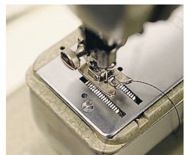
Den gamla mekaniska multisömsmaskinen i verkstaden används enbart till textilier som behöver kantsys. Till övriga läderarbeten använder Kristian Metsälä en modernare symaskin.
